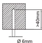
Diamètre entraxe :  $\varnothing 6\text{mm}$
